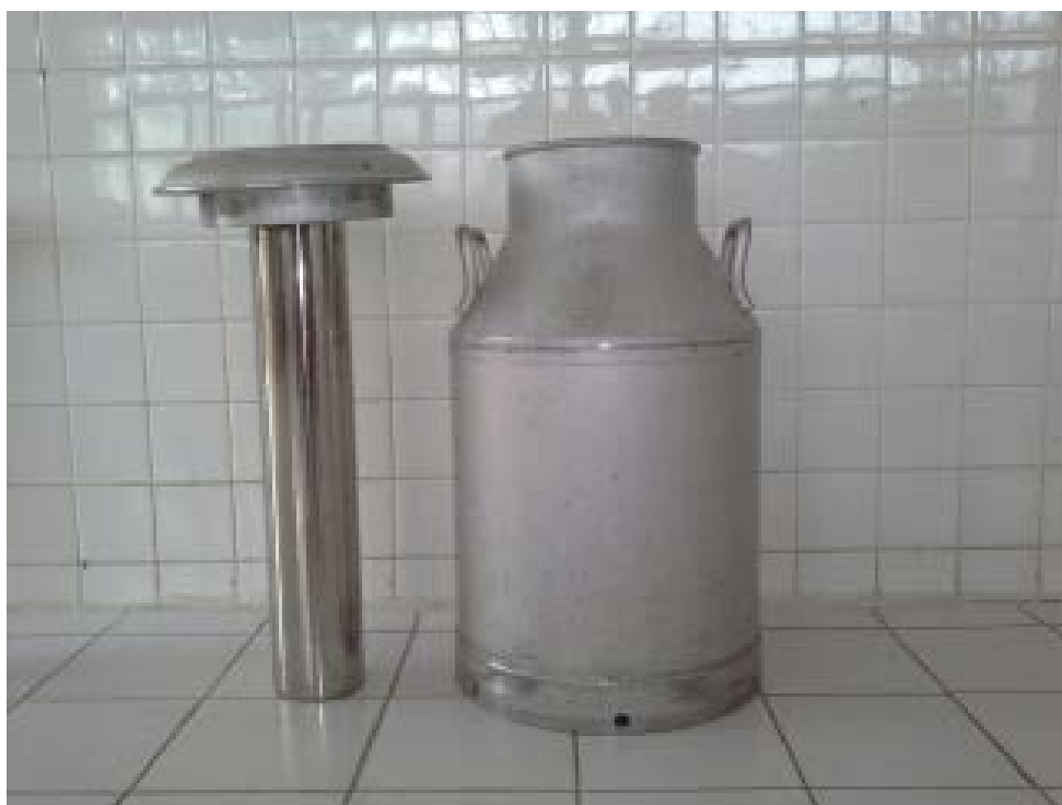
ภาพผนวกที่ 2 ลักษณะของแกนให้ความเย็นและถังนมที่ดัดแปลงเสร็จแล้ว
