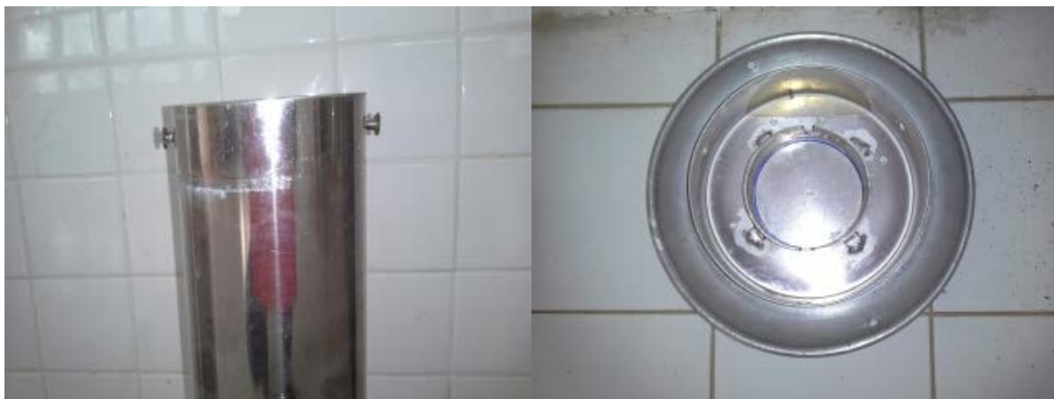
ภาพผนวกที่ 3 ลักษณะของตัวล็อกของแกนให้ความเย็นและฝาถังนมที่ดัดแปลงแล้ว
