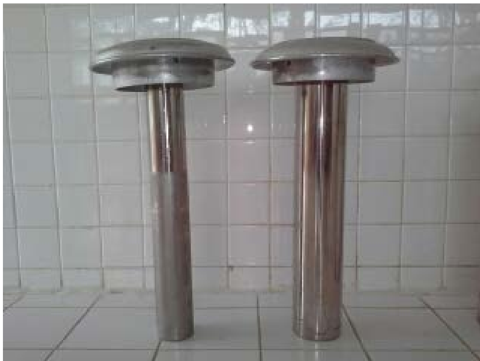
ภาพผนวกที่ 1 ลักษณะของแกนให้ความเย็นขนาด 3 และ 4 นิ้ว
